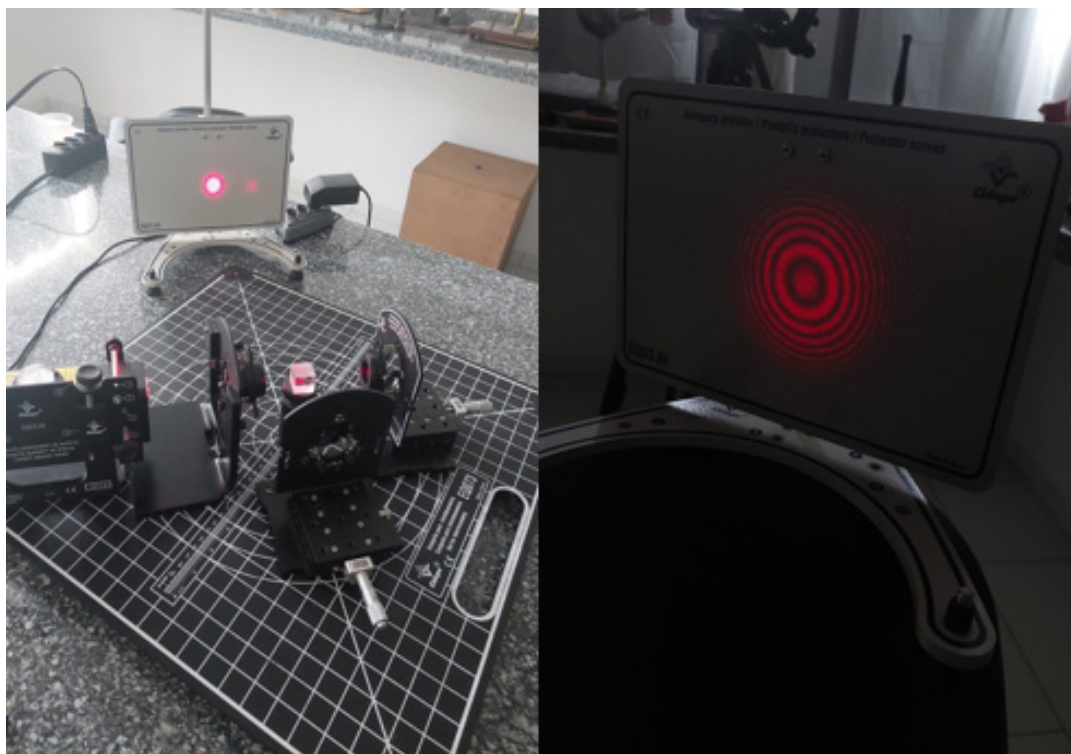
Fig. 04 - Versão didática do interferômetro de Michelson e Morley construída pela CIDEPE. Ao lado esquerdo está a configuração do experimento e ao lado direito o resultado obtido. A figura 04 apresenta a configuração experimental e o resultado fenomenológico obtido.
